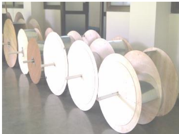
Gambar 5. Model-model rotor kincir angin dengan berbagai variasi dimensi yang dibuat dan diselidiki dalam penelitian.
