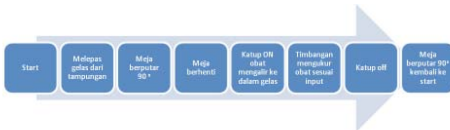
Gambar 8. Diagram Kerja Sistem Takar Obat Serbuk
