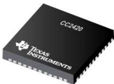
Gambar 4. Chip ChipCon CC2420 dari Texas Instruments (Karlof, 2004)
