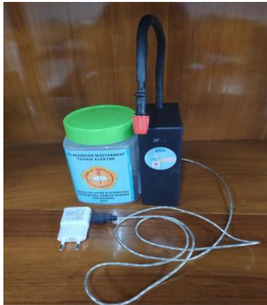
Gambar 12. Hasil akhir alat dispenser hand sanitizer otomatis dengan sticker edukasi pemakaian alat.
