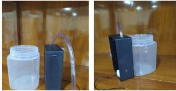
Gambar 8. Sambungan selang ke mesin pompa air serta penempatannya ke dalam kotak pelindung komponen dan kemudian terhubung dengan bak penampungan
