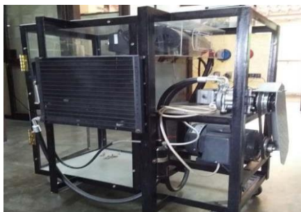
Gambar 1. Alat peraga sistem pengkondisian udara pada mobil hasil rakitan
