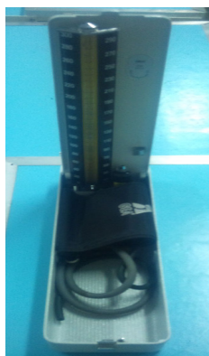
Gambar 1. Sphygmomanometer dengan Merkuri
