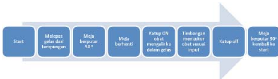
Gambar 8. Diagram Kerja Sistem Takar Obat Serbuk
