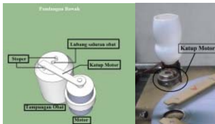
Gambar 9. Desain dan Hasil Implementasi Katup Menggunakan Motor DC
