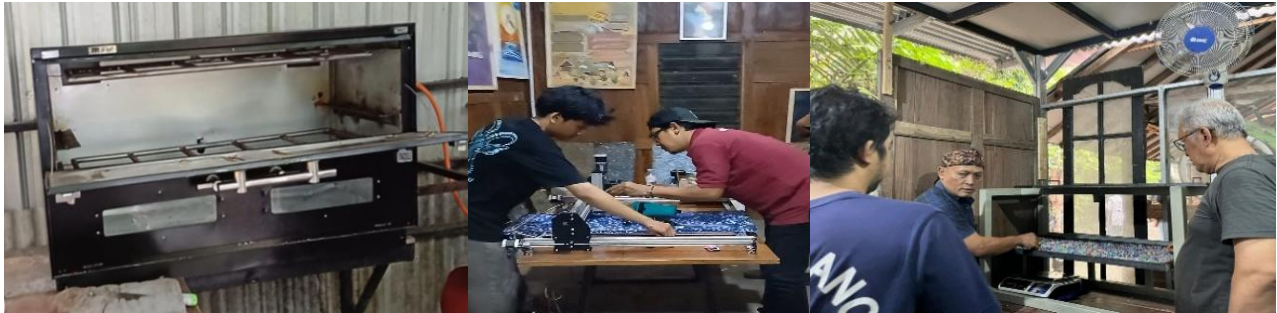
Gambar 3. Oven dan Press Hidrolik untuk membuat WPC dan Mesin CNC untuk Produk Seni
